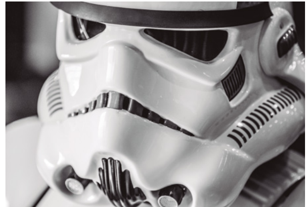
Máscara de PS Alto Impacto termo-conformada. El acabado es brillante
