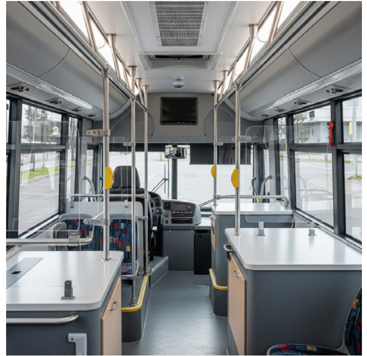
interior de autobús con policarbonato para protección individual y solid surface para superficies limpias
